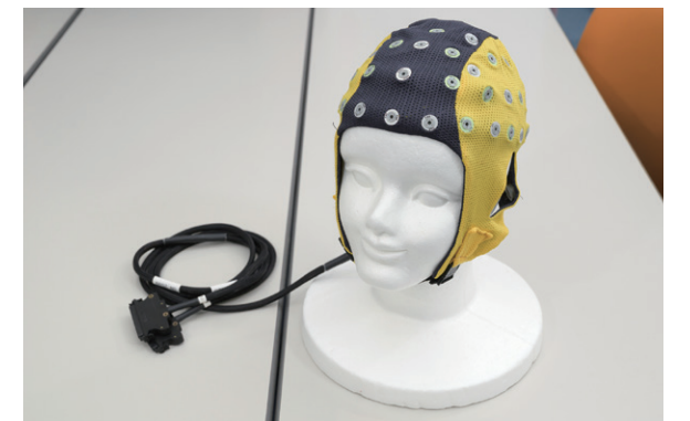
脳波計の電極とキャップ。脳波計測はfMRIに比べて低コストで行える
