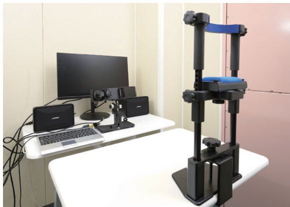
被験者の視線の動きや瞳孔径の変化をリアルタイムで測定する装置「アイトラッカー」
