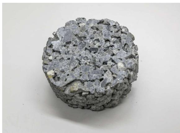
空洞を設けたセメントコンクリートのサンプル
