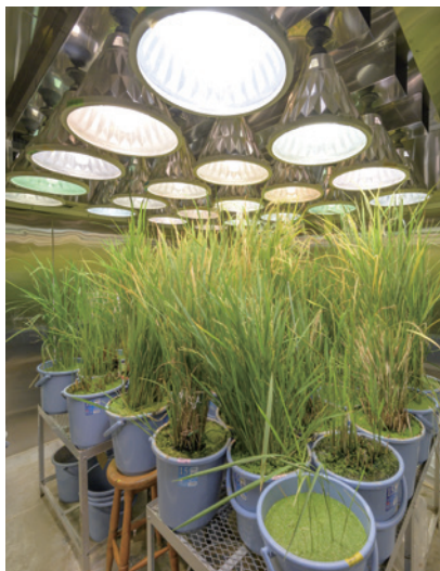
南大沢キャンパスの温室・実験圃場に設けられている人工気象室。年間を通じて室温が26度に保たれ、日照時間は13時間に設定されている。
